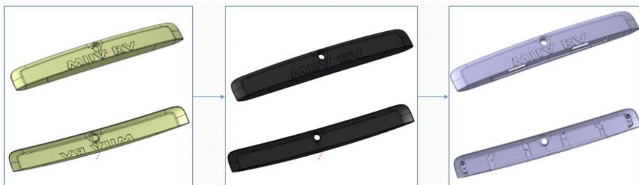
Fig. 6 : Modelarea tridimensională a piesei utilizând Catia
