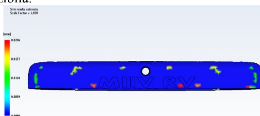
Fig. 17: Zone cu risc de apariție al retasurilor
