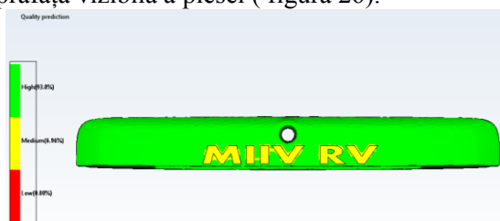
Fig. 25: Calitatea modelului îmbunătățit
