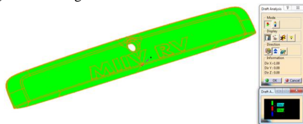
Fig. 7: Analiză de draft
