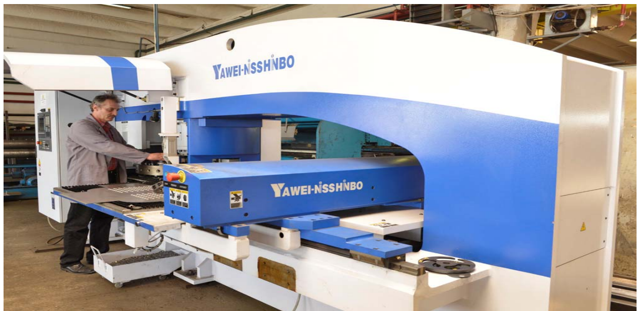
Fig.2.3. Presa mecanica pentru perforat tabla. Aspect general.
