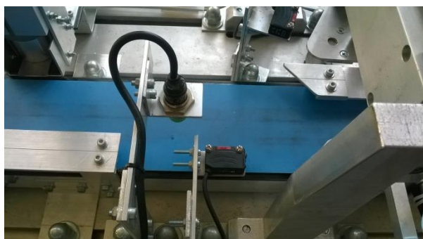
Fig. 4.2 Senzor inductiv (stanga) si senzor fotoelectric (dreapta), folositi la identificarea carcaselor
