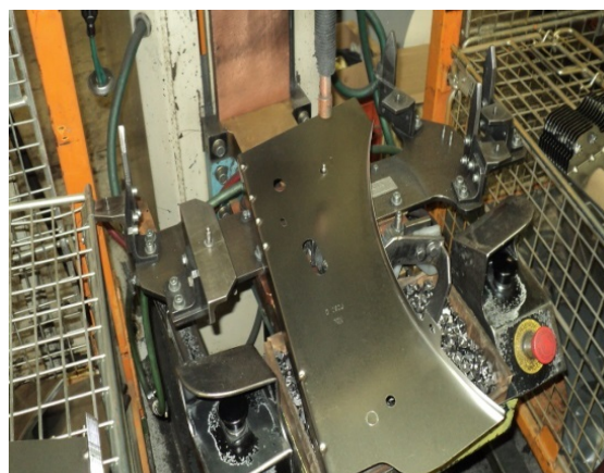
Fig.7. Sudarea unei piulite in plan Y(post suplimentarDPD180.1)
