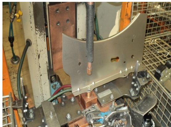
Fig.7. Sudarea unei piulite in plan Y(post suplimentarDPD180.1)
