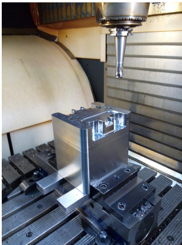
Fig.17.Operația de Roughing(degroșare)
