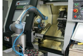
Fig. 37. Utilizarea roboților la prinderea și desprinderea semifabricatelor[5]
